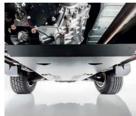
OSŁONA PODWOZIA Z ZESTAWEM MONTAŻOWYM nr kat. MZ35300 + MZ353000S1
