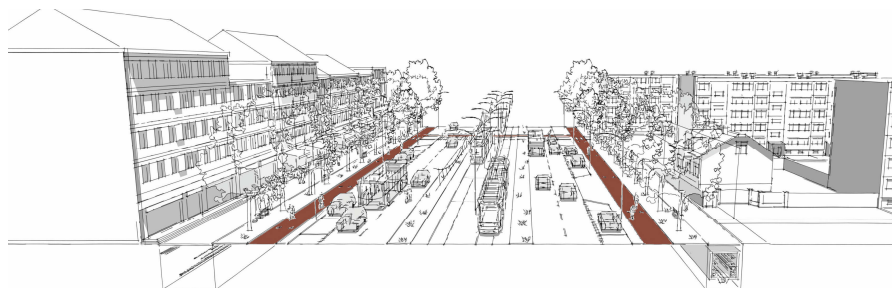
rys.10. Elementy ulicy – infrastruktura rowerowa. (Źródło: BRG)
