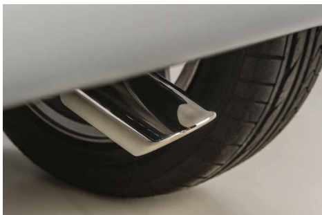
KOŃCÓWKA RURY WYDECHOWEJ, CHROMOWANA nr kat. MZ330438
