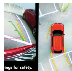
SYSTEM KAMER 360 STOPNI
