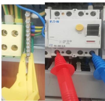
Rys.23.8. podłączenie sond podczas badania RCD
