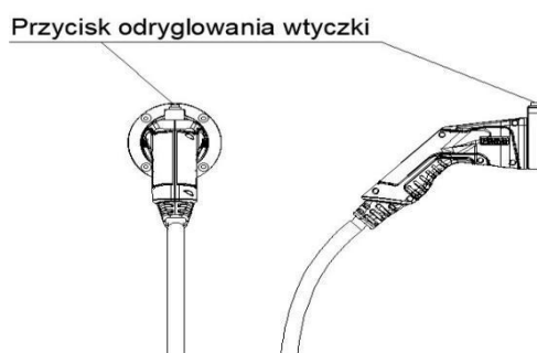
Rys.13.1. Odryglowanie zadokowane wtyczki w stacji.
