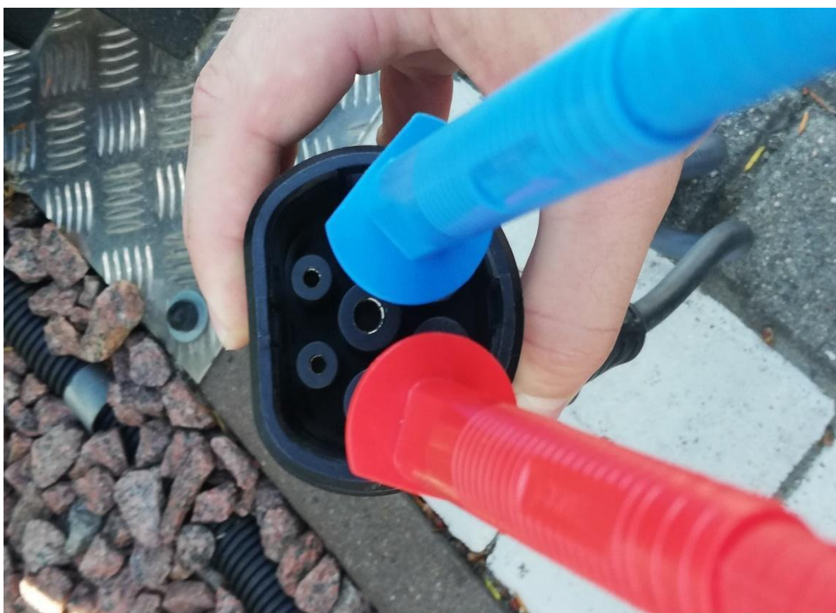
Rys. 23.5. Sondy pomiarowe we wtyczce typ -2. Badanie Riso L1-N dla odcinka Wtyczka typ-2 Stycznik 4NO
