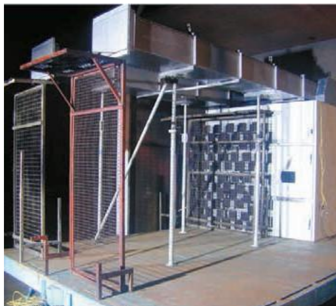
UniGear ZS1 w czasie prób odporności na łuk wewnętrzny
