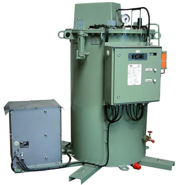
Rys. 4: dławik gaszący EGE do krótkotrwałej eksploatacji bez konserwatora (z tzw. szczeliną powietrzną między poziomem oleju i pokrywą dławika oraz z opornikiem pomocniczym zamocowanym na podwoziu dławika gaszącego)
