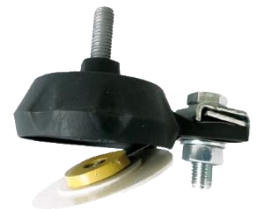
Ogranicznik odłączony – do wymiany
