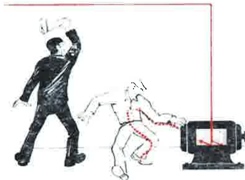
Rysunek Nr 23 Uwolnienie porażonego spod działania prądu elektrycznego o napięciu do 1 kV przez przecięcie lub zerwanie przewodów od strony zasilania.
