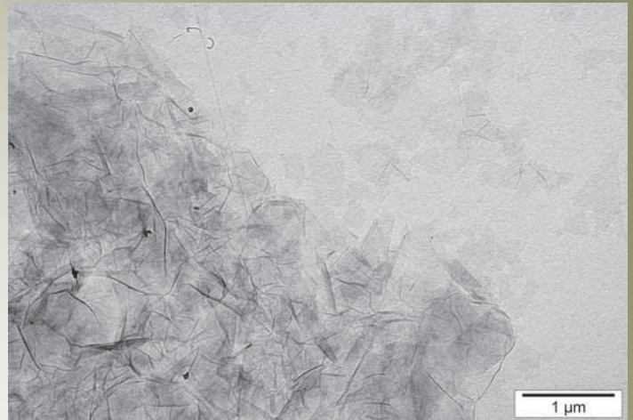
Płaszczyzna i małe płatki tlenku grafenu (obraz z transmisyjnego mikroskopu elektronowego)
